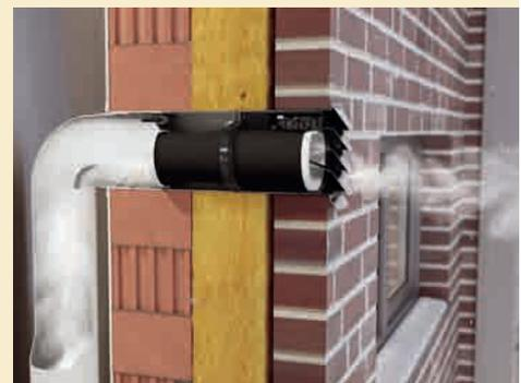
**Intelligente Steuerung:** Die ins Gerät integrierte Elektronik registriert den Abluftstrom des Dunstabzugs und öffnet den Durchlass via automatische Klappen vollständig (hier: von Naber).
